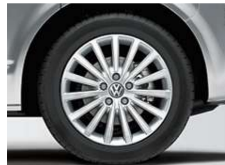
Vier Leichtmetallräder „Canberra“ 8 J x 18. Mit Reifen 255/45 R 18. Sie sind nicht als Reserverad bestellbar.
