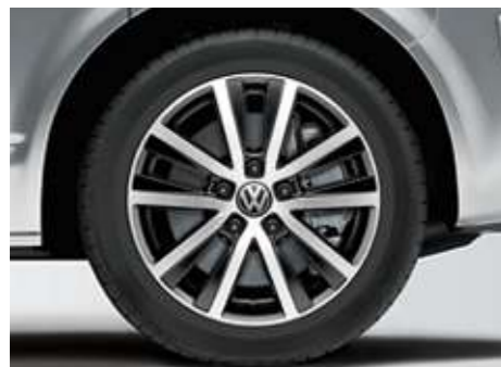
Vier Leichtmetallräder „Cascavel“ 7 J x 17. Oberfläche glanzgedreht in Schwarz. Mit Reifen 235/55 R 17.
