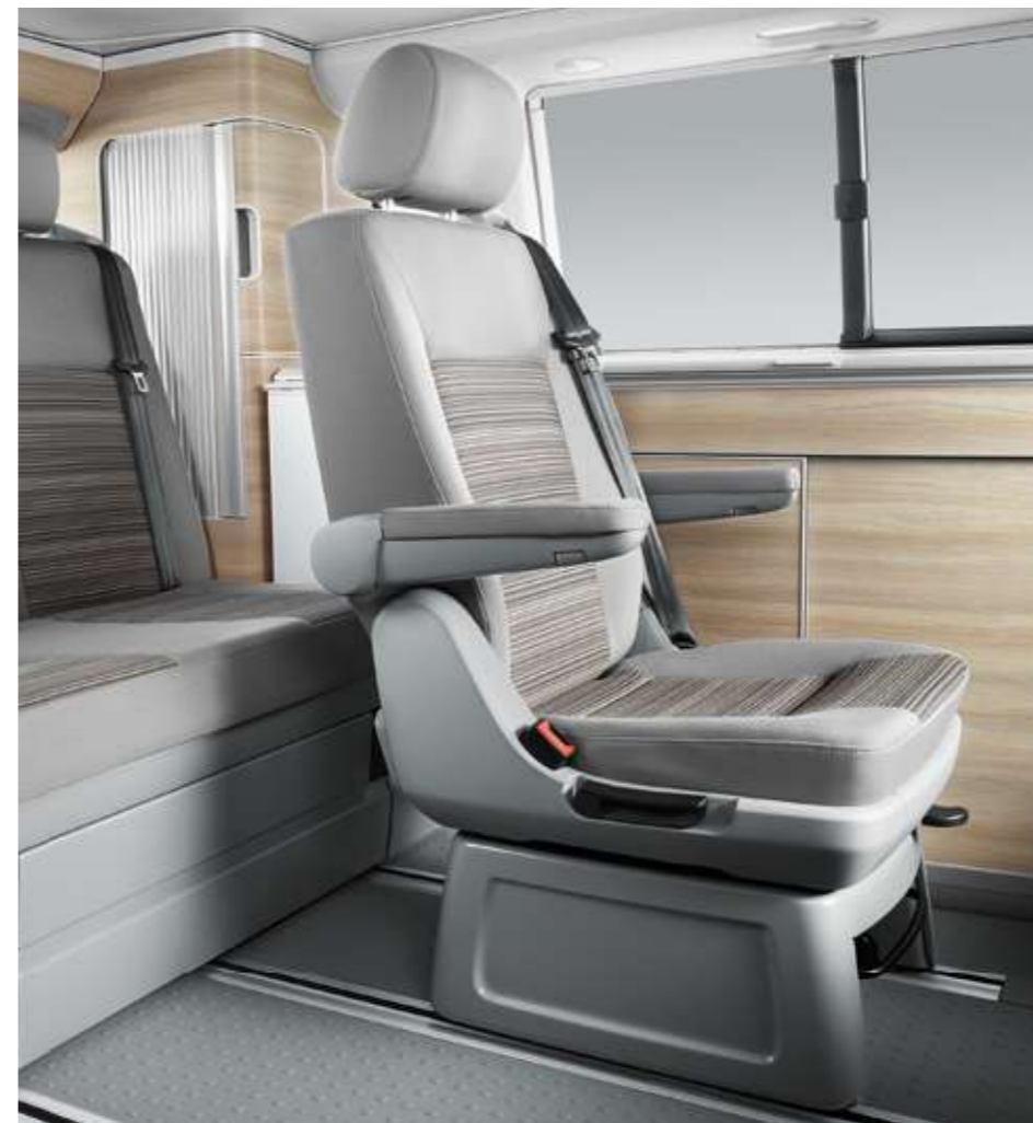
Der Einzelsitz im Fahrgastraum. Der Zusatzsitz mit bequemen Armlehnen ist klappbar, drehbar, längs verschiebbar und herausnehmbar. Er ist mit einem Dreipunkt-Sicherheitsgurt und ISOFIX-Befestigungspunkten ausgestattet. Nicht lieferbar beim California mit Allradantrieb 4MOTION.
