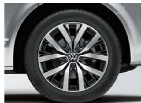
Vier Leichtmetallräder „Toluca“ 8 J x 18. Mit Reifen 255/45 R 18. Diese Leichtmetallräder sind nicht als Reser- verad bestellbar.
