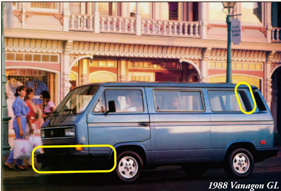
1988モデルから大型ウレタンバンパーが標準採用され、見た目が大きく変わった。また、これまでドアを通じて排気していたフロースルーベンチレーションが、サイドウインドーの後部から排気するようになり、車内全体が換気できるようになった。
