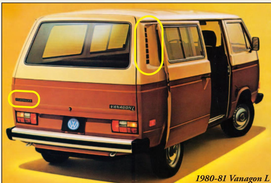
初期型はリアのエアインテーク・ルーバーがボディパネルに直接プレスされている。これがエンジンルームに空気を導入するものだ。ドイツ本国でディーゼルエンジンが追加された1981年2月頃から、空冷エンジン搭載車も含めて全車プラスチック製になる(次ページ参照)。
