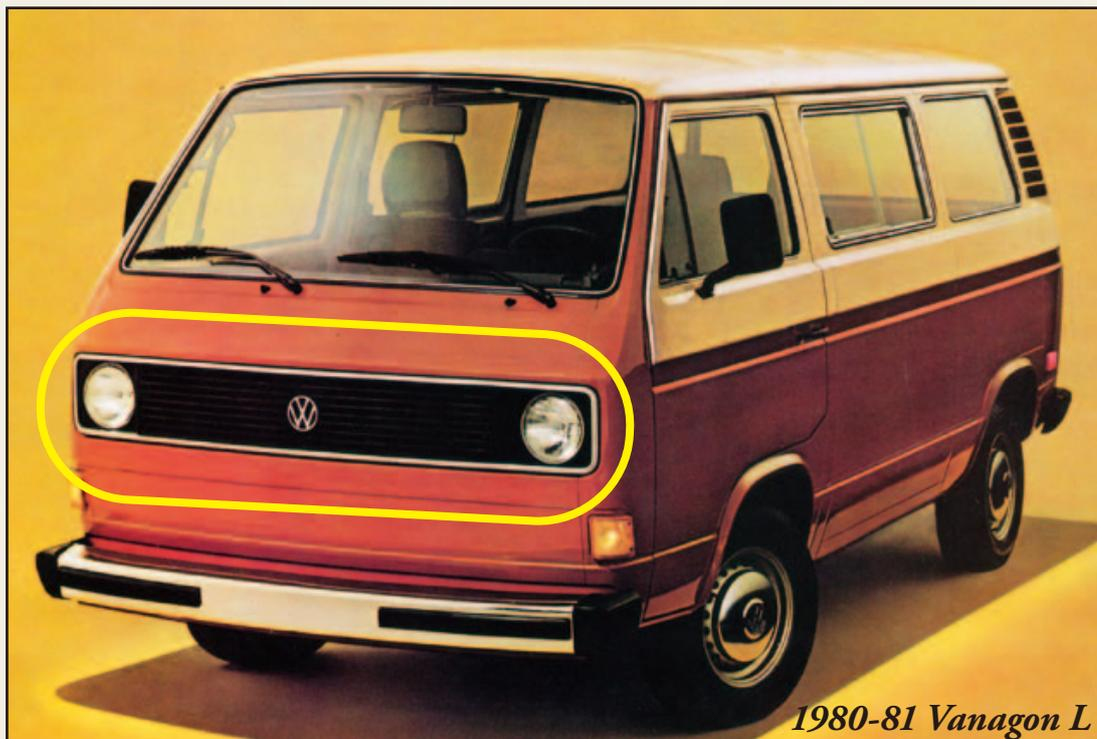
なんといっても初期型の特徴は、グリルが1段であること。空冷エンジンゆえにラジエーターが必要ないからだ。大きなグリルは換気用の外気取り入れ口で、ゴルフなどの水冷モデルとデザインに共通性を持たせたものだ。
