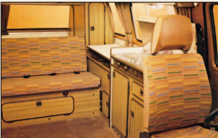
キャンピング内装のレイアウトや装備は、ベイウインドー時代を踏襲している。1982モデルまでは、ガス系統を備えるP27と、ガスのないP22をラインナップ。1983モデルからP27のみとなる。
