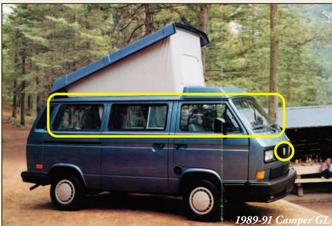
キャンパーもGLと同様に大型バンパーとベンチレーションが1988~1991モデルの特徴となる。また、全モデルとも1988モデルの途中からフロントエンブレムが大きくなる。
