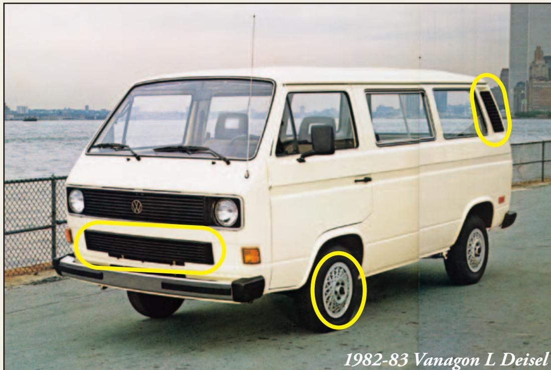
1982モデルから水冷ディーゼルエンジンが追加され、外気導入グリルの下にラジエターグリルが追加された。なお空冷モデルは1段グリルのままである。また、1981年後期からリアのエアインテークがプラスチック製になったのも、ドイツ本国でディーゼルが登場したためである。ホイールキャップがメッシュデザインのフルカバータイプに変更。これにより、現代的なルックスとなった。
