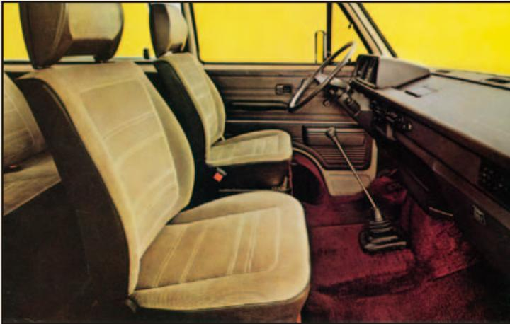
初期のダッシュボードはカドの部分のみパッドが貼られていた。フロントシートにアームレストはなく、ドアパネル側にアームレストが備わる。4速MTと3速ATが選択できた。
